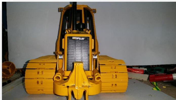
Die fehlenden Teile am Schild habe ich aus PS ind der Stärke 2mm gebaut, das Material lässt sich super biegen und an bestehende Formen anpassen, sowie sehr gut kleben.
