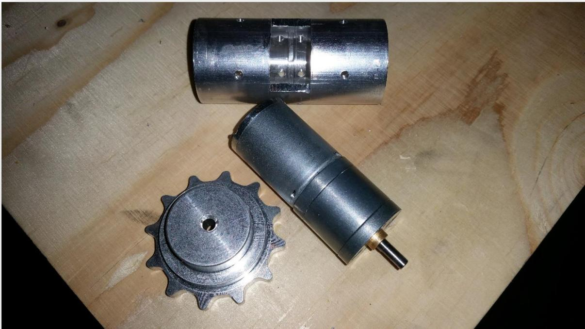
Der Getriebemotor ist 6V 80  $\frac{1}{\text{min}}$ , 25mm Durchmesser und das Turas ist von Cti.
