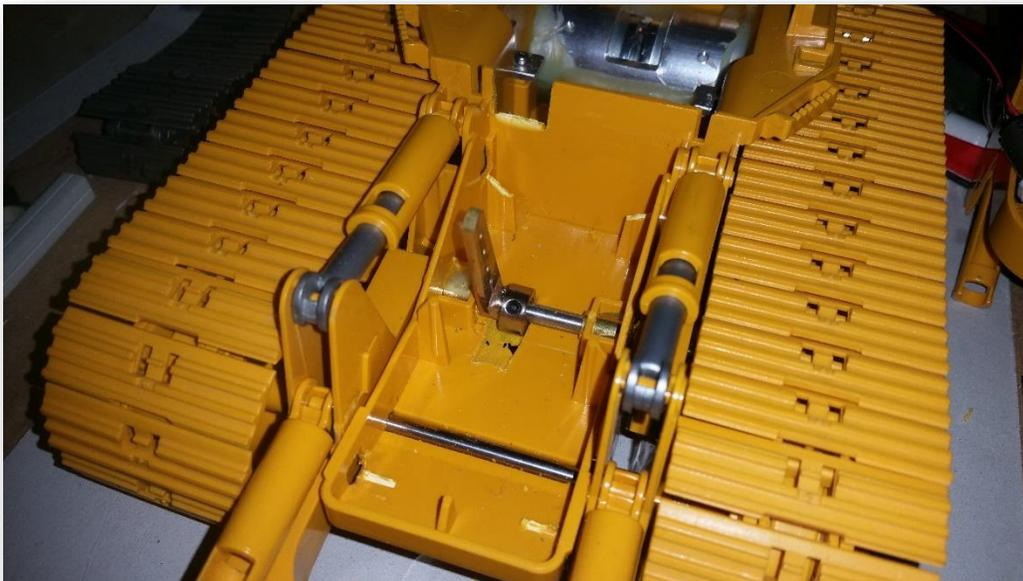
Für die Betätigung des Schild habe ich an der Schubrahmenlagerung Messingrohrstücke als Lagerbüchsen eingeklebt und eine 5mm Welle eingebaut mit einem Hebel um den Schubrahmen zu betätigen. Den Antrieb mache ich mit einer kleinen Spindel.
