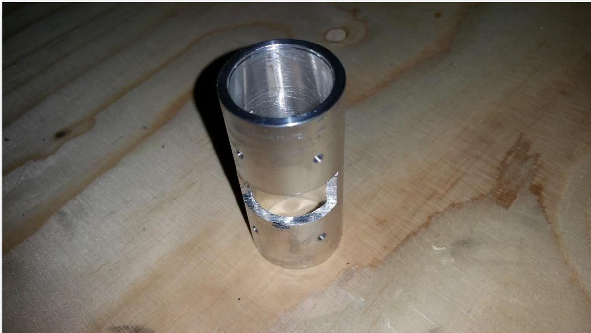
Dieses Alu-Rohr ist mit M3 Gewinde versehen, mit denen die Getriebemotoren mittels M3-Madenschrauben fixiert werden können.
